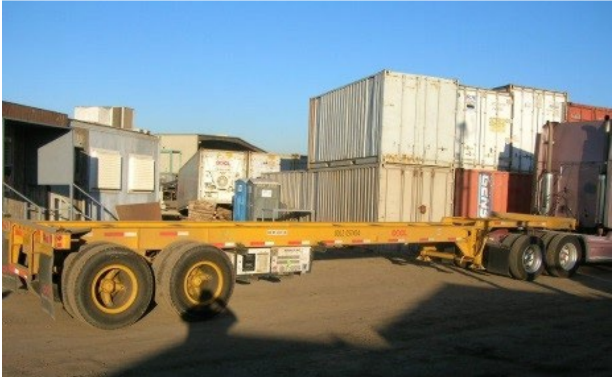
Figure I-6. Under-slung TRU Gen Set
