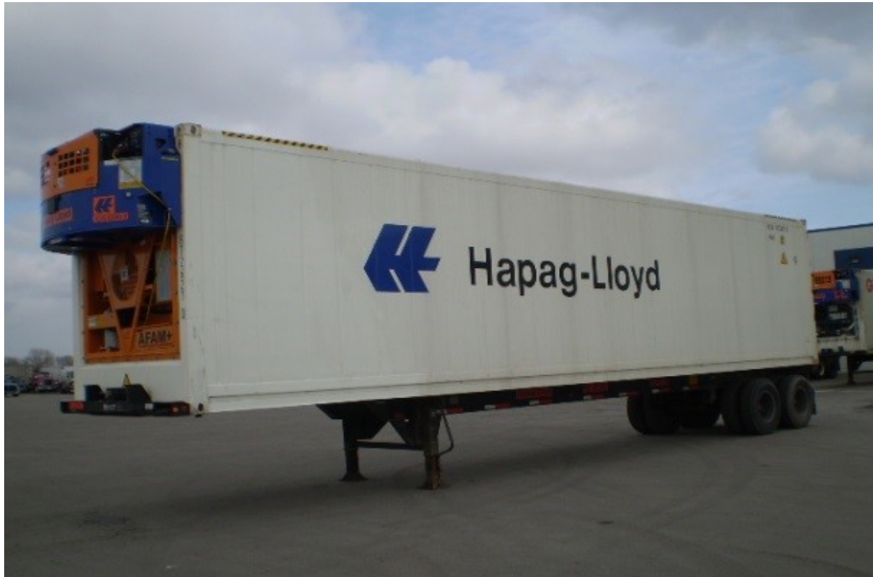
Figure I-5. Pin-on TRU Gen Set
